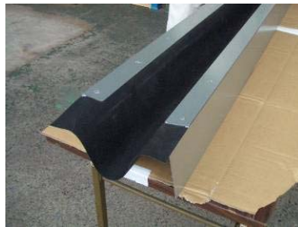
写真-1 端部の止水ゴム（止水ゴムが張りだしている）
