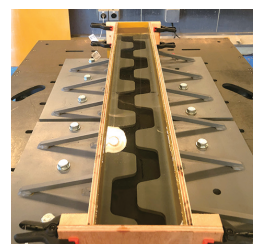
▲止水性能試験実施状況
