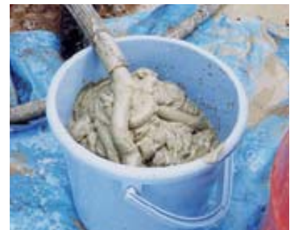
▲A液とB液を混合し、可塑状モルタルとなったWフィルグラウト
