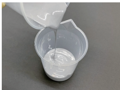
▲ 主剤と硬化剤の混合 (流動性あり)
