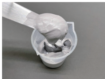
▲ 主剤・硬化剤・促進剤の混合物 (吹付け塗装で防食塗膜を形成)
